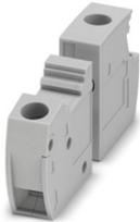
Borne pasamuros, tipo de conexión: Conexión por tornillo con cápsula de tracción, Conexión por tornillo con cápsula de tracción, número de polos: 1, corriente de carga: 32 A, sección: 0,2 mm<sup>2</sup> - 6 mm<sup>2</sup>, dirección de conexión del conductor con respecto a la dirección de enchufe: 0 °, anchura: 8,1 mm, color: gris
