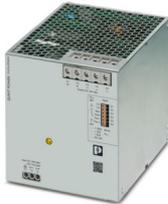
Fuente de alimentación QUINT POWER conmutada en primario para montaje sobre carril DIN, con curva característica de salida seleccionable y tecnología SFB (Selective Fuse Breaking), pintura de protección y MOSFET de desacoplamiento integrado, entrada: monofásica, salida: 24 V DC/40 A
