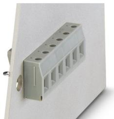
Borne pasamuros, tipo de conexión: Conexión por tornillo con cápsula de tracción, Conexión por soldadura, número de polos: 1, corriente de carga: 32 A, sección: 0,2 mm<sup>2</sup> - 6 mm<sup>2</sup>, AWG 24 - 10, dirección de conexión del conductor con respecto a la dirección de enchufe: 0 °, anchura: 10 mm, color: gris
