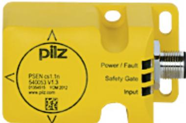
Interruptor de seguridad RFID, 2 salidas por semicond. seguras, conector M12 5 polos, 4 direcciones de accionamiento, IP67, distancia de conmutación típ. 21 mm, Sao = 15 mm, Sar = 40 mm, VPE = 1 ud. interruptor encriptado.
