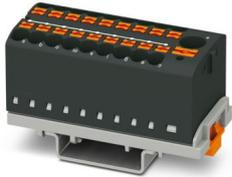
Bloque para distribución, Bloque con alineación vertical y alimentación integrada, tensión nominal: 690 V, corriente nominal: 24 A, número de conexiones: 19, tipo de conexión: Conexión push-in, Derivación, sección: 0,14 mm<sup>2</sup> - 4 mm<sup>2</sup>, Conexión push-in, Conexión colectiva, Sección de dimensionamiento: 6 mm<sup>2</sup>, sección: 0,5 mm<sup>2</sup> - 10 mm<sup>2</sup>, clase de montaje: NS 35/7,5, NS 35/15, color: negro
