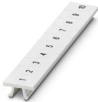
Tira de cinta Zack, Tiras, blanco, rotulado, rotulable con: CMS-P1-PLOTTER, rotulación longitudinal: números correlativos de 1 ... 10, 11 ... 20 etc. hasta 491 .. 500, clase de montaje: enclavar, para ancho de borne: 6,2 mm, superficie útil: 6,15 x 10,5 mm, Número de índices individuales: 10
