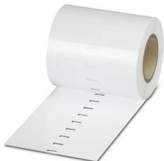
Marcador para bornes, Rollo, blanco, sin rotular, rotulable con: THERMOMARK ROLL 2.0, THERMOMARK ROLL, THERMOMARK ROLL X1, THERMOMARK ROLLMASTER 300/600, THERMOMARK X1.2, THERMOMARK S1.1, Perforado, clase de montaje: enclavar, encajar en ranura para índice plana, para ancho de borne: 6,2 mm, superficie útil: 6,35 x 6,15 mm, Número de índices individuales: 16000
