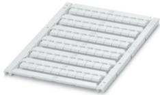
Marcador para bornes, Estera, blanco, sin rotular, rotulable con: TOPMARK NEO, TOPMARK LASER, BLUEMARK ID COLOR, BLUEMARK ID, BLUEMARK CLED, THERMOMARK PRIME, THERMOMARK CARD 2.0, THERMOMARK CARD, clase de montaje: enclavar, para ancho de borne: 6,2 mm, superficie útil: 5,4 x 4,7 mm, Número de índices individuales: 60
