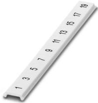
Tira de cinta Zack plana, Tiras, blanco, rotulado, rotulación longitudinal: Números impares 1-19, 21-39 etc. hasta 81-99, clase de montaje: enclavar, para ancho de borne: 6,2 mm, superficie útil: 5,15 x 6,15 mm, Número de índices individuales: 10
