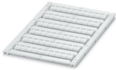
Marcador para bornes, disponible: por esteras, blanco, rotulado según las indicaciones del cliente, clase de montaje: encajar en ranura para índice plana, para ancho de borne: 6,2 mm, superficie útil: 5,4 x 4,7 mm, Número de índices individuales: 60
