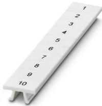
Tira de cinta Zack, Tiras, blanco, rotulado, rotulable con: CMS-P1-PLOTTER, Rotulación transversal: números correlativos de 1 ... 10, 11 ... 20 etc. hasta 491 .. 500, clase de montaje: enclavar, para ancho de borne: 6,2 mm, superficie útil: 6,15 x 10,5 mm, Número de índices individuales: 10
