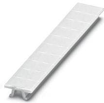
Marcador para bornes, Tiras, blanco, rotulado, rotulable con: CMS-P1-PLOTTER, rotulación longitudinal: U, V, W, N, GND, U, V, W, N, GND, clase de montaje: enclavar, para ancho de borne: 6,2 mm, superficie útil: 6,15 x 10,5 mm, Número de índices individuales: 10
