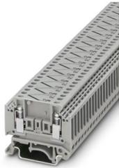
Bornes para termopares, TC tipo K, tensión nominal: 400 V, corriente nominal: 1 A, número de conexiones: 4, número de polos: 2, tipo de conexión: Conexión por tornillo, 1er piso, sección: 0,2 mm<sup>2</sup> - 4 mm<sup>2</sup>, clase de montaje: NS 35/7,5, NS 35/15, NS 32, color: gris
