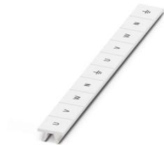
Marcador para bornes, Tiras, blanco, rotulado, rotulable con: CMS-P1-PLOTTER, longitudinal: U, V, W, N, GND, U, V, W, N, GND, clase de montaje: enclavar, para ancho de borne: 10,2 mm, superficie útil: 10,15 x 10,5 mm, Número de índices individuales: 10
