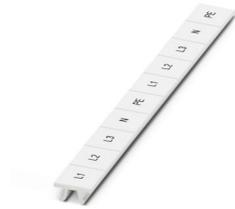
Marcador para bornes, Tiras, blanco, rotulado, rotulable con: CMS-P1-PLOTTER, longitudinal: L1, L2, L3, N, PE, L1, L2, L3, N, PE, clase de montaje: enclavar, para ancho de borne: 10,2 mm, superficie útil: 10,15 x 10,5 mm, Número de índices individuales: 10
