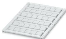
Marcador para bornes, disponible: por esteras, blanco, rotulado según las indicaciones del cliente, clase de montaje: encajar en ranura para índice alta, para ancho de borne: 10,2 mm, superficie útil: 8,9 x 9,6 mm, Número de índices individuales: 36
