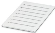
Marcador para bornes, disponible: por esteras, blanco, rotulado según las indicaciones del cliente, clase de montaje: encajar en ranura para índice alta, para ancho de borne: 8,2 mm, superficie útil: 7,6 x 10,5 mm, Número de índices individuales: 56
