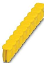
Cubierta para eje de conductores, 10 polos, para bornes de resorte (ST) y bornes para carril con tecnología Push-in (PT) con ancho de 5,2 mm
