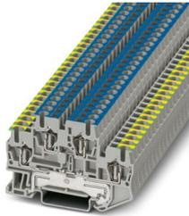
Borne de doble piso conductor de protección, tensión nominal: 500 V, corriente nominal: 22 A, tipo de conexión: Conexión por resorte, 1er y 2º piso, Sección de dimensionamiento: 2,5 mm<sup>2</sup>, sección: 0,08 mm<sup>2</sup> - 4 mm<sup>2</sup>, clase de montaje: NS 35/7,5, NS 35/15, color: gris
