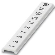
Tira de cinta Zack plana, Tiras, blanco, rotulado, rotulación longitudinal: Números impares 1-19, 21-39 etc. hasta 81-99, clase de montaje: enclavar, para ancho de borne: 4 mm, superficie útil: 5,15 x 4,15 mm, Número de índices individuales: 10
