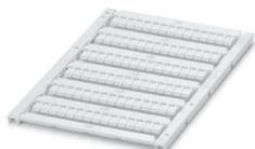
Marcador para bornes, disponible: por esteras, blanco, rotulado según las indicaciones del cliente, clase de montaje: encajar en ranura para índice plana, para ancho de borne: 4,2 mm, superficie útil: 3,4 x 4,7 mm, Número de índices individuales: 90
