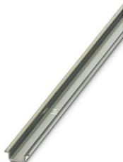
Carril simétrico sin perforar, Variante de embalaje con 10 unidades (20 m), según EN 60715, material: Acero, galvanizado, pasivado de capa gruesa, Perfil estándar, color: plateado
