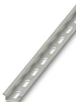
Carril simétrico perforado, Variante de embalaje con 10 unidades (20 m), según EN 60715, material: Acero, galvanizado, pasivado de capa gruesa, Perfil estándar, color: plateado
