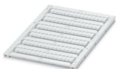
Marcador para bornes, Estera, blanco, sin rotular, rotulable con: TOPMARK NEO, TOPMARK LASER, BLUEMARK ID COLOR, BLUEMARK ID, BLUEMARK CLED, THERMOMARK PRIME, THERMOMARK CARD 2.0, THERMOMARK CARD, clase de montaje: enclavar, para ancho de borne: 4,2 mm, superficie útil: 3,4 x 4,7 mm, Número de índices individuales: 90
