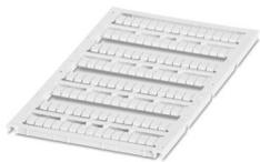
Marcador para bornes, disponible: por esteras, blanco, rotulado según las indicaciones del cliente, clase de montaje: encajar en ranura para índice plana, para ancho de borne: 4,2 mm, superficie útil: 3,6 x 5,1 mm, Número de índices individuales: 120
