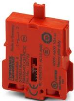
Contactador para interruptor de paro de emergencia modular con contacto de apertura forzada (NC) para la desconexión orientada a la seguridad, en combinación con equipo de evaluación adecuado apto hasta PL e (EN ISO 13849-1), SIL 3 (EN IEC 62061)
