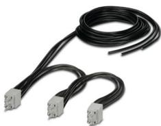
Puente de inserción en bucle trifásico para 3 módulos de la familia CONTACTRON con conexión por tornillo y ancho de carcasa de 22,5 mm, longitud de cable entre los módulos: 0,3 m, cable de conexión: 2 m
