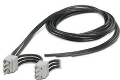
Puente de inserción en bucle trifásico para 4 módulos de la familia CONTACTRON con conexión por tornillo y ancho de carcasa de 22,5 mm, cable de conexión: 1 m
