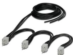
Puente de inserción en bucle trifásico para 4 módulos de la familia CONTACTRON con conexión por tornillo y ancho de carcasa de 22,5 mm, longitud de cable entre los módulos: 0,3 m, cable de conexión: 2 m
