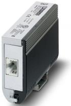
Protección contra sobretensiones según clase E<sub>A</sub> (CAT6<sub>A</sub>), para Ethernet Gigabit (hasta 10 GBit/s), Token Ring, FDDI/CDDI, ISDN, DS1. Adecuada para Power over Ethernet (PoE++ / 4PPoE) "Modo A" y "Modo B". Conector intermedio RJ45 con conductor de puesta a tierra por separado y pie de encaje de puesta a tierra para carril NS 35.
