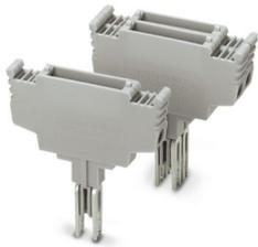
**Conector de componentes**, para conexión de componentes bipolares en el borne de base, fijación con puntos de embornaje roscados, 19 mm de alto, máx. 16 A
