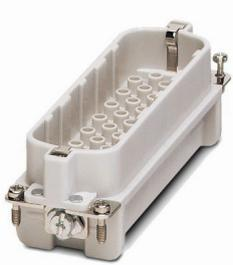
Inserto de contactos, número de polos: 64+PE, tamaño: D64, Macho, Conexión crimpada, 250 V, 10 A, 0,14 mm<sup>2</sup> ... 2,5 mm<sup>2</sup>
