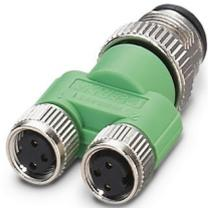
Distribuidor en Y, 4-polos, sin apantallar, Conector recta M12, codificación: A, a Hembra recta M8, codificación: A y Hembra recta M8, codificación: A
