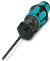
Atornillador dinamométrico, con par preajustado de 0,2 Nm y accionamiento hexagonal de 4 mm para conector enchufable M8
