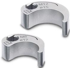
Inserto enchufable para el montaje de conectores M8 con moleteado longitudinal y diámetro de moleteado de 12 mm, para accionamiento hexagonal de 4 mm
