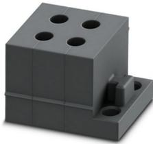
Pasacables, pequeña, número de conductores: 4, tipo: Cable redondo, hendido, diámetro exterior del cable: 4x 3 mm ... 4 mm, material: NBR, color: negro, longitud: 29,5 mm, anchura: 19,5 mm, altura: 17 mm
