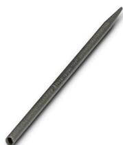
Punzón, simplifica la introducción de los manguitos PMH sobre los conductores; introducir el conductor en la punta del punzón y hacer pasar el manguito al conductor. Para diámetro exterior de conductor de: 2,0 -2,5 mm
