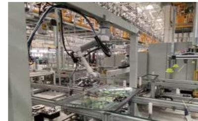
Encolado de parabrasas
