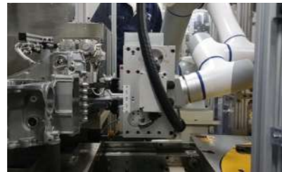
Atornillado de caja de transmisión
