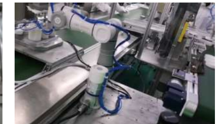
Carga y descarga de cubiertas plásticas
