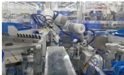
Instalación de anillos de sellado de juntas automotrices
