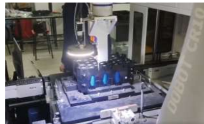
Atornillado de bloqueo de la batería de almacenamiento de energía
