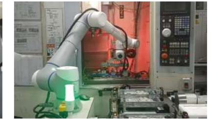
Carga y descarga de robot compuesto
