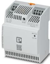
Fuentes de alimentación conmutadas de primario, STEP POWER, Conexión push-in, Montaje sobre carril y directo, entrada: 1 fásico, salida: 48 V DC / 2,5 A, ajustable desde 48 V DC ... 56 V DC, Aplicación PoE hasta 120 W
